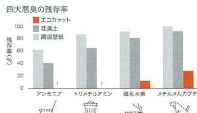
※試験結果は当社試験によるものです。部屋の使用条件、気象・換気などの環境条件によって異なります。
