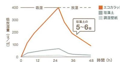
※試験結果は当社試験方法(相対湿度50%→90%→50%にした時の吸湿/放湿量を示します)によるものです。他建材、家具の配置、気象、換気などの環境条件によって異なります。
